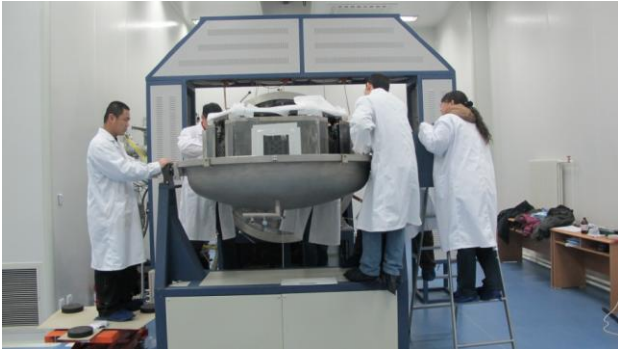
(左: 将镜片固定在镀膜机上 右: 镀膜前检查镜片)
